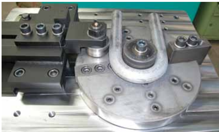
243 Standard Tischaufbau mit Gegenhalter, Mitnehmer und Biegebolzen Standard base with bending roll, driver and bending bolt
