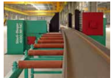
122 Träger vorspannen / überhöhen Beam cambering / bending
