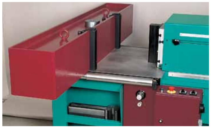
162 Richten bis HEA 260 Straightening up to HEA 260
