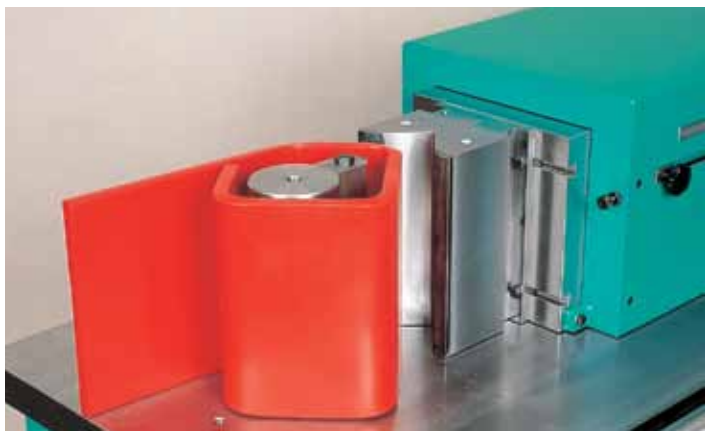
161 Biegen 300/30 Bending 12" x 1 1/4"
