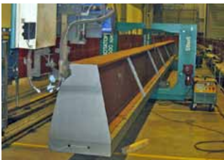
316 ROTATOR mit Schweißroboter kombiniert In Combination with welding robot
