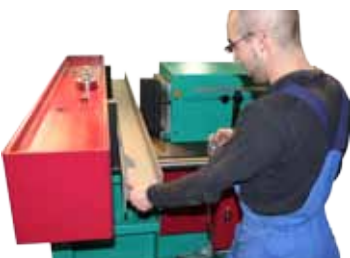
105 Richten mit Richtkabel Straightening with hand cable
