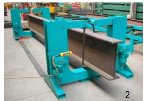
302 Arme schliessen automatisch Arms closes automatically
