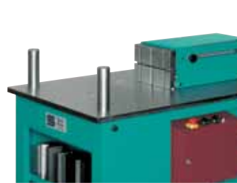
102 Richten mit Richtbolzen (420 HE) Straighten with straightening pins
