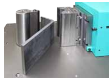
68 Schwere Biegearbeiten verrichten Heavy bending works with Stierli
