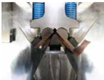
65 Abdruckfreies Biegen Bending without marks
