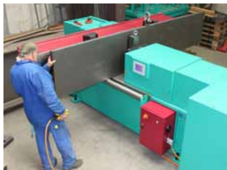
275 Einfaches Richten von dicken Stahlplatten Simple straightening of thick steel plates
