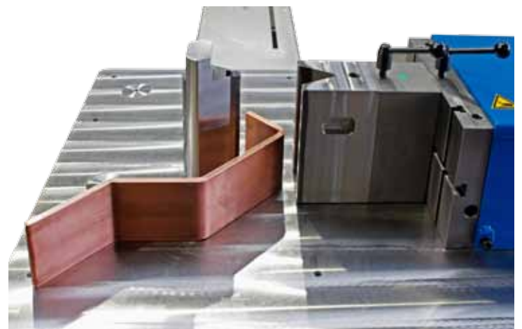
202 Biegen mit Standard Prisma und schneller Winkelprogrammierung mit CNC-W Bending with standard vee-block and fast programming with CNC-W
