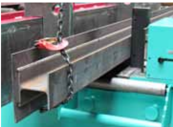
119 Geschweisste Träger richten Welded beam straightening
