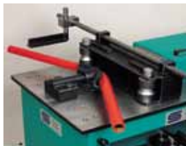
322 Rohre biegen Pipe bending
