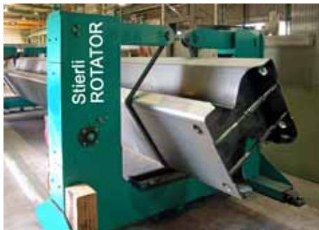
311 Erdungsanschluss durch die Kette Chain with integrated earth connection
