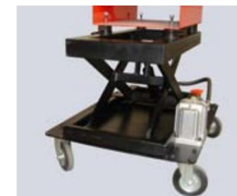
IL CARRELLO IDRAULICO REGOLABILE IN ALTEZZA CON RUOTE PIVOT TANTI È INDICATO PER FOGLI DI LAMIERA DI GRANDI DIMENSIONI
