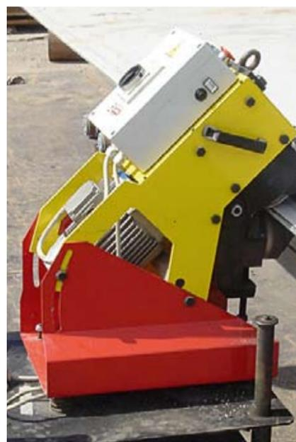
Smussatrice per lamiere GBC CHALLENGE 15 in lavorazione, adatta per lavorare sia fogli di lamiera di grandi dimensioni sia bandelle di larghezza ridotta. La macchina una volta piazzata sul bordo lamiera, si muove automaticamente sulla stessa sino a fine lavorazione, senza intervento dell'operatore.
