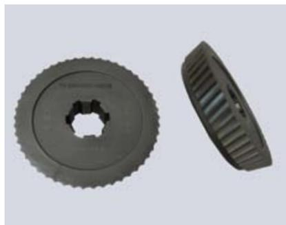
Diverse tipologie di frese che variano per dentatura, materiale e durezza, sono disponibili in funzione delle caratteristiche del materiale da lavorare.
