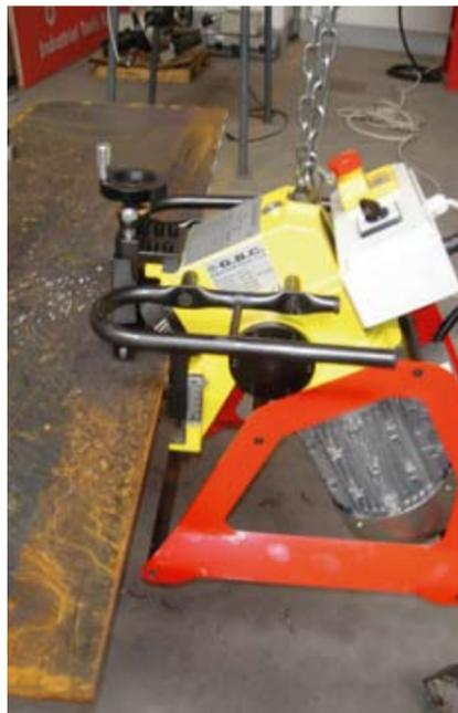
Smussatrice per lamiere GBC CHALLENGE 12, con dimensioni compatte e peso contenuto per una maggiore portabilità nell'area di lavoro. La macchina una volta piazzata sul bordo della lamiera, si muove automaticamente sulla stessa sino a fine lavorazione, senza intervento dell'operatore.
