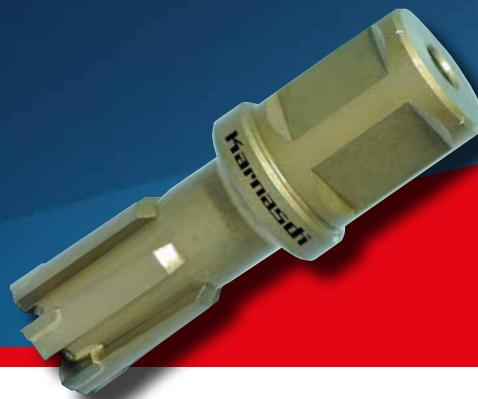
Tige Weldon 19 mm / 3/4" se fixant à la majorité des perceuses à embase magnétique; hélice conique pour un dégagement efficace des copeaux et une efficacité de coupe élevée; géométrie de coupe élaborée pour le rail, permettant de couper le rail aussi dur que le UIC 54 et UIC 60.
